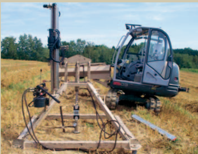
■ Kod montaže preko terrafixa mogući su i veći strojevi za uvrtanje.
